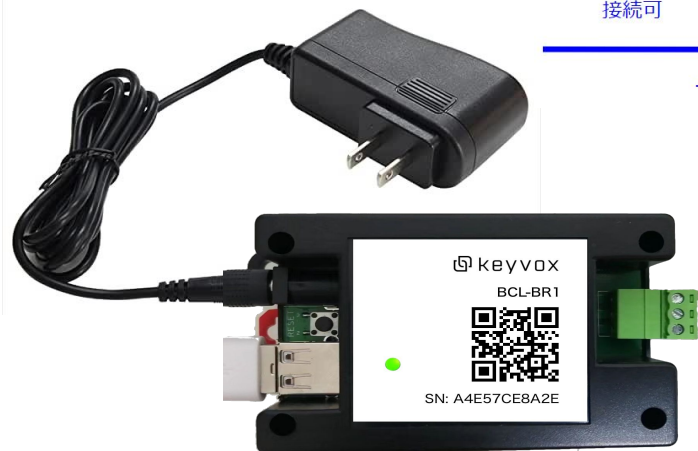
BCL-BR1 (BLEモジュール、制御盤)
